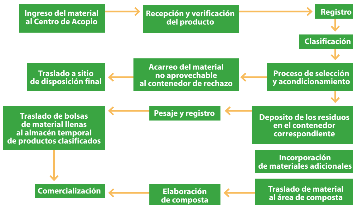
Diagrama de flujo de los puntos verdes para el acopio de residuos valorizables. Fuente: Proyecto ejecutivo puntos verdes.
